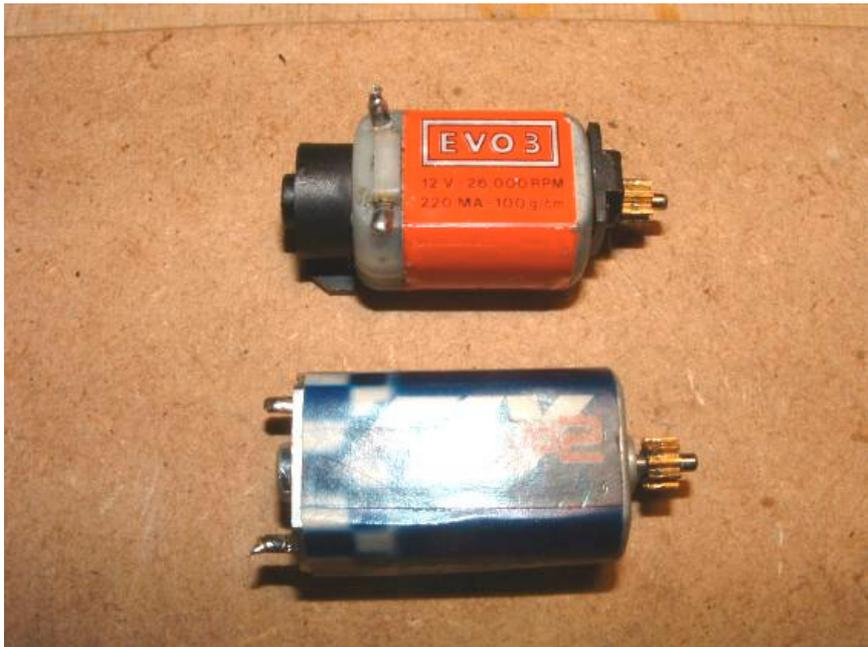
...und fertig ist die Laube. Aber unbedingt Adapter am Motorhalter festkleben (ein Tropfen zwischen Adapterteile und Motor schadet auch nicht), der hält sonst z.B. in den „lottrigen“ Fly Halterungen überhaupt nicht...Kleber nicht in die Lager bringen! Einziger Nachteil – Ölen ist echte Fingerakrobatik unter einer guten Lampe.
